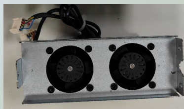
Back Side Fan View After Fan Reversal
